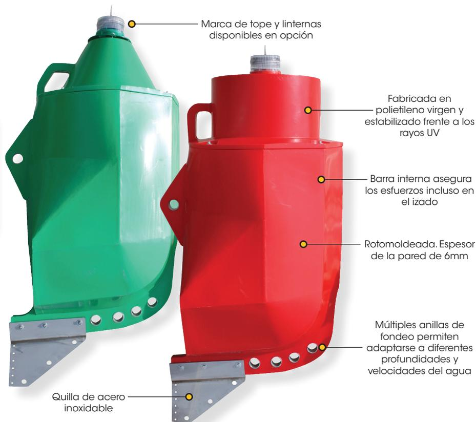
**La boya de señalización Sealite SL-B750 de 750mm de diámetro está diseñada para una variedad de aplicaciones y es particularmente adecuada para las corrientes de aguas rápidas de hasta 6 nudos.**
